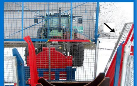
Die von uns in der Form entwickelte Führungsschiene ist so aufgebaut, das beim Einsetzen der Motorsäge die Säge auf Zug gehalten werden kann. Somit gleitet die Säge durch das Eigengewicht nicht gleich nach unten und kann auch nicht die andere Richtung nach oben sofort aus der Führungsschiene springen.
