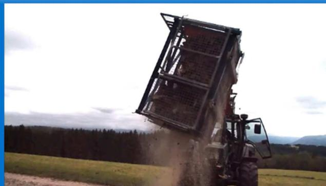
Mit Hilfe der Entleerungsklappe kann das gereinigte Holz in Säcke oder Paletten gekippt werden. Je nach Frontlader bzw. Stapler kann auch eine Kipphöhe über 4 m erzeugt werden.
