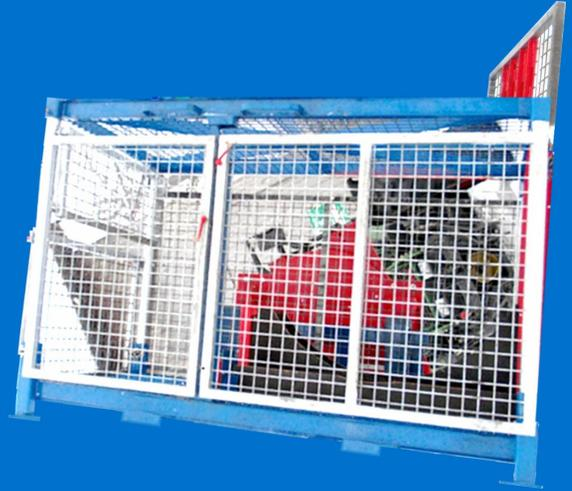
Das größte Problem bei herkömmlichen Sägekörben ist das anfallende Sägemehl. Dieses wird mit ausgekippt und bleibt im ofenfertigem Brennholz! Beim BSR Multisägekorb wird durch den Reinigungstrommeleffekt das gesägte Brennholz komplett von Sägemehl und Holzspänen „befreit“!
