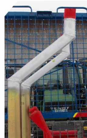
Nach den Schnitten werden durch den begehbaren Multisägekorb die herausnehmbaren Stützen und Führungsschienen entnommen. Dieses ist eine Sache von ca. 10 Sekunden.
