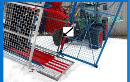
Unser Vario Sägegitter ist in die Raster von 25, 33, und 50 Zentimeter aufgeteilt und kann bei der Beschickung schon gebündelter Holzbündel durch einen Kran oder Frontlader ca. 40cm weggeklappt werden. Somit ist genügend freier Platz für die Kranzange. Durch die sehr hohe Bauweise ist höchste Sicherheit beim Sägen geboten. Dieses ist bei uns einzigartig!
